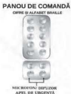
Fig. 14. Panou de comandă ascensor
