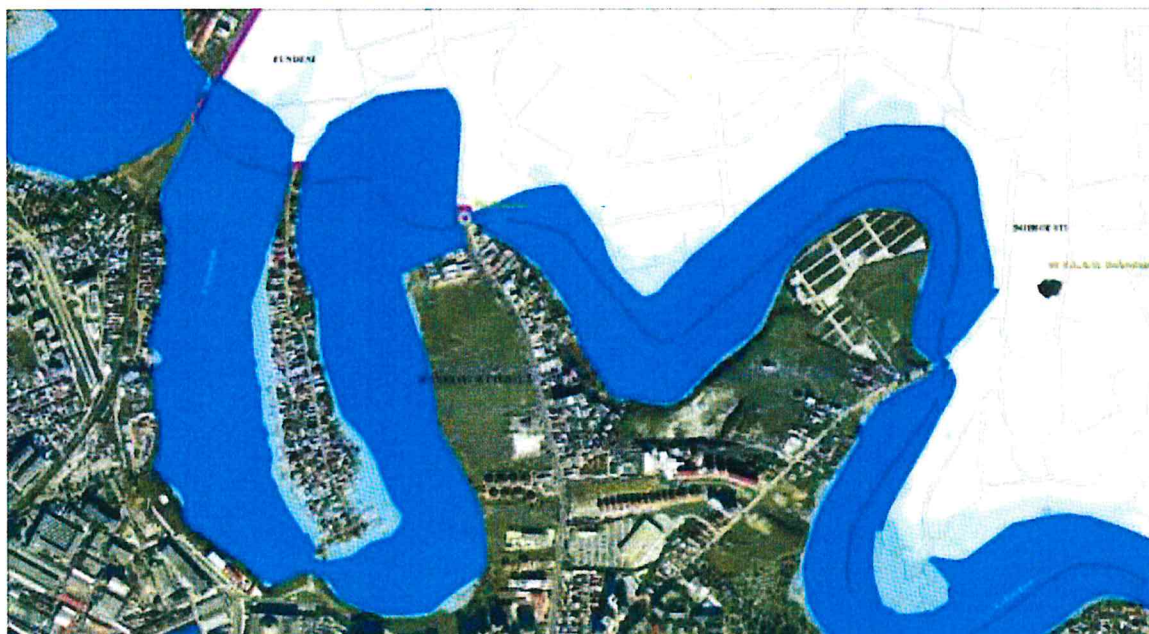
Figura 37 - Harta Sectorului 2 cu benzile de inundabilitate pentru debitele cu probabilitățile de depășire 1% și 0,1% - râul Colentina (4).
