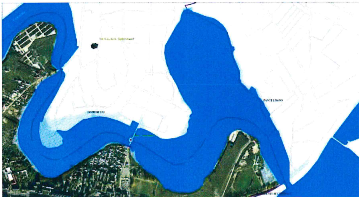
Figura 38 - Harta Sectorului 2 cu benzile de inundabilitate pentru debitele cu probabilitățile de depășire 1% și 0,1% - râul Colentina (5).
