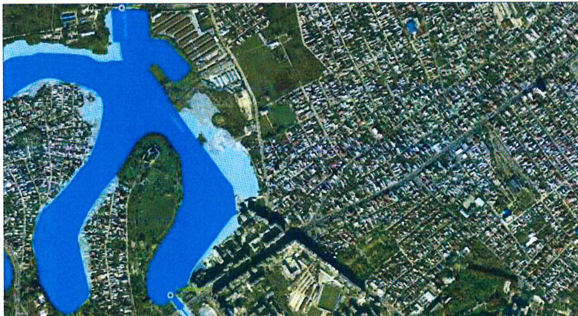
Figura 35 - Harta Sectorului 2 cu benzile de inundabilitate pentru debitele cu probabilitățile de depășire 1% și 0,1% - râul Colentina (2).
